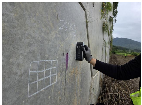
경사계를 이용한 경사도 측정
